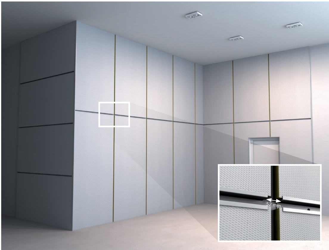
2.4 Montera resterande väggsorbenter och vågräta HAT-profiler genom att arbeta in mot mitten..
