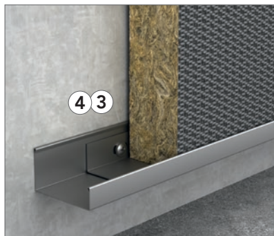
40 mm J-profil (25/40/13 mm) och vinkelbeslag används i botten för att ge stöd åt väggabsorbenterna när de monteras utan stöd från golvet eller som en lösning i flera nivåer. När 1 mm tjock J-profil används behövs inte vinkelbeslaget.
