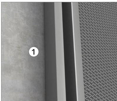
HAT-profiler skruvas direkt i väggen.
